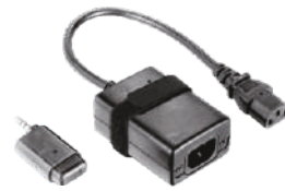
POWER SYNCHRO RELAY sterowanie bezprzewodowe, uruchamiane zdalnie podczas włączania projektora, montowane na przewodzie zasilającym projektora, współpracujące ze wszystkimi modelami projektorów, również tych bez gniazda Trigger 12V. Działa jedynie w połączeniu ze sterowaniem bezprzewodowym RF.
